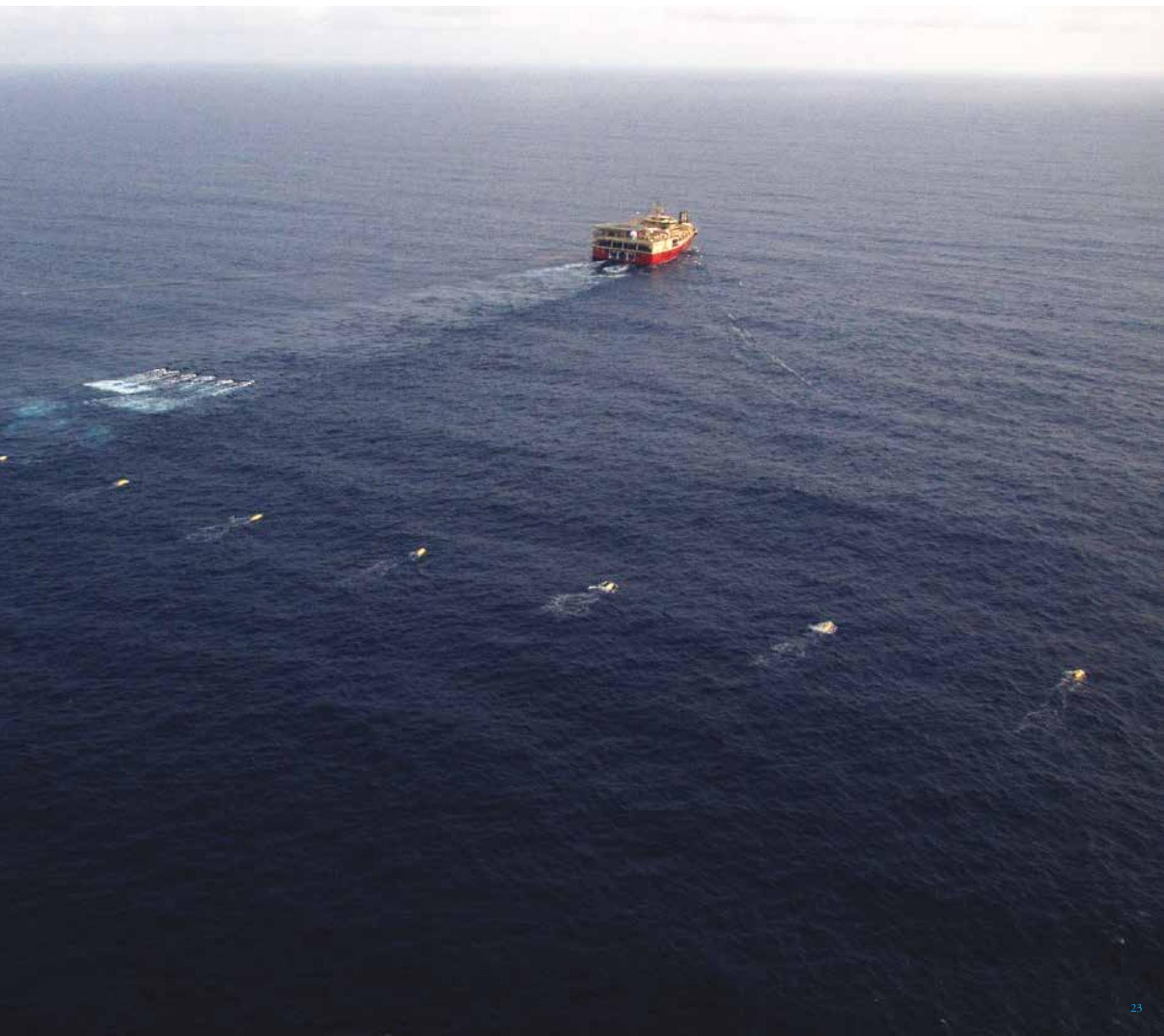
Estes hidrofones captam o retorno, ou “eco” do som emitido por uma fonte sonora também rebocada pelo navio de pesquisa. A fonte sonora libera ar-comprimido de uma forma controlada, em intervalos regulares, que causa uma propagação sonora que viaja em alta velocidade. As ondas sonoras se propagam, sendo inicialmente refletidas pelo leito oceânico, e posteriormente, pelas estruturas geológicas depositadas em camadas ao longo do leito oceânico.
