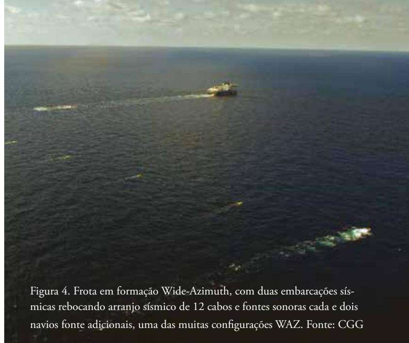
Figura 4. Frota em formação Wide-Azimuth, com duas embarcações sísmicas rebocando arranjo sísmico de 12 cabos e fontes sonoras cada e dois navios fonte adicionais, uma das muitas configurações WAZ. Fonte: CGG
