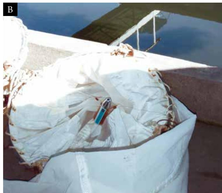
Figura 4 – Rede bongô (a) com fluxômetro (b) acoplado para as coletas de zooplâncton
